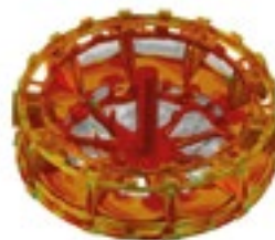
Центробежное литье корпуса двигателя
