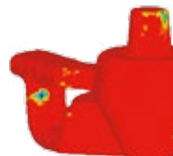
Фрагменты стержня с незаполненными или недостаточно плотными участками
