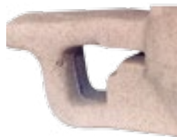
Фрагменты стержня с незаполненными или недостаточно плотными участками
