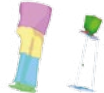
Конечная схема утепления (слева) минимизирует усадочную пористость (справа)
