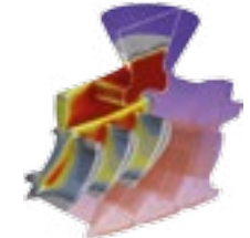
Поле температур и доля твердой фазы
