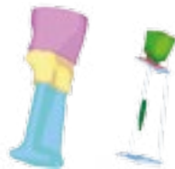
Начальная схема утепления (слева) и усадочная пористость (справа)
