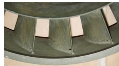
Трещины в отливке (АО «ОДК» – «Салют»)
