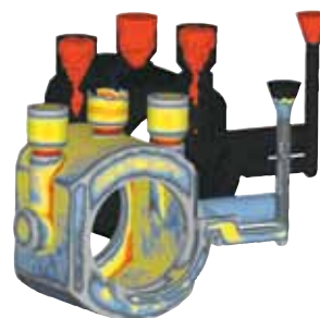
Прогнозирование усадочных раковин при литье стальной отливки
