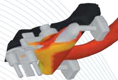
Движение расплава по стержню
