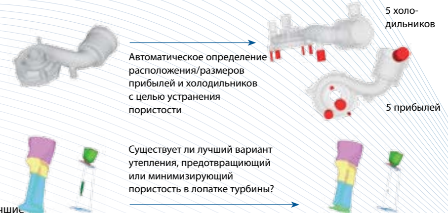
Утепление (слева) и пористость (справа) до оптимизации
