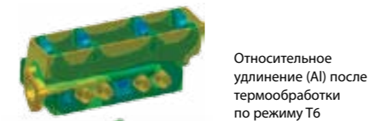
Относительное удлинение (литейный чугун) в литом состоянии. Предоставлено Fonderia Casati
