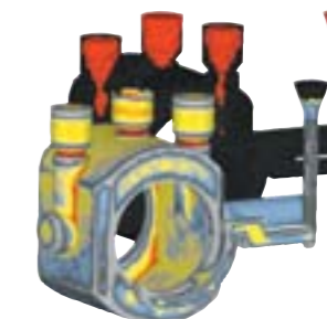
Прогнозирование усадочных раковин при литье стальной отливки
